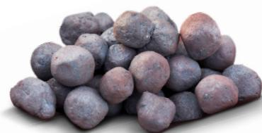
Élément parmi les plus communs de la planète, le fer compose environ 5 % de la croûte terrestre. Nous faisons l'extraction du minerai de fer sous la roche de surface pour ensuite le concasser et le concentrer. Nous pouvons ensuite le transformer en boulettes de fer utilisables dans les hauts fourneaux ou l'acheminer
